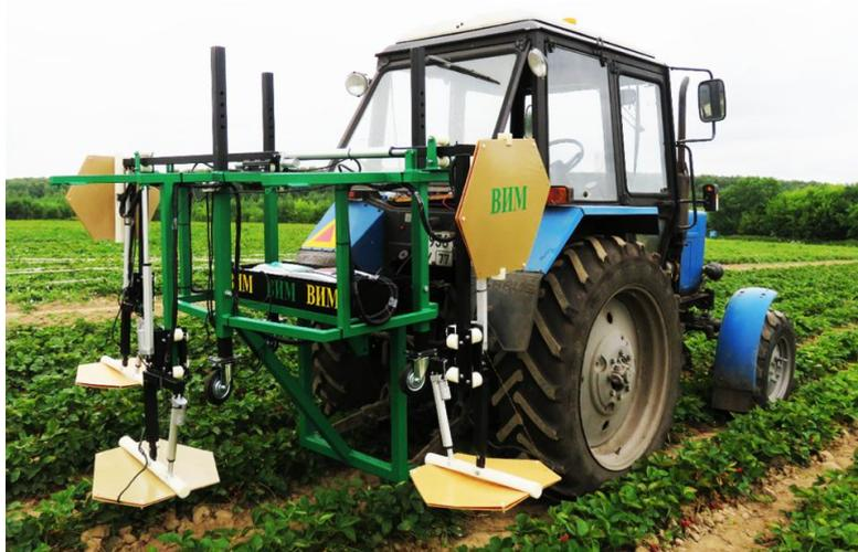
Рисунок 1 – Выполнение автоматизированным агрегатом технологической операции МИО земляники садовой
