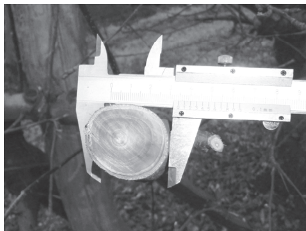
Рис. 3. Задиры ветки диаметром 35 мм при низком качестве среза с размещением под углом 25° к плоскости резания
