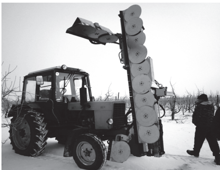
Рис. 1. Контурный обрезчик с дисковыми рабочими органами OBS Profi производства фирмы «Binger Seilzuq» с одновременным ограничением параметров кроны в вертикальной и горизонтальной плоскости
