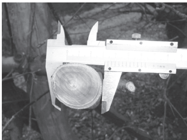
Рис. 2. Качественный срез ветки диаметром 32 мм, расположенной перпендикулярно плоскости резания
