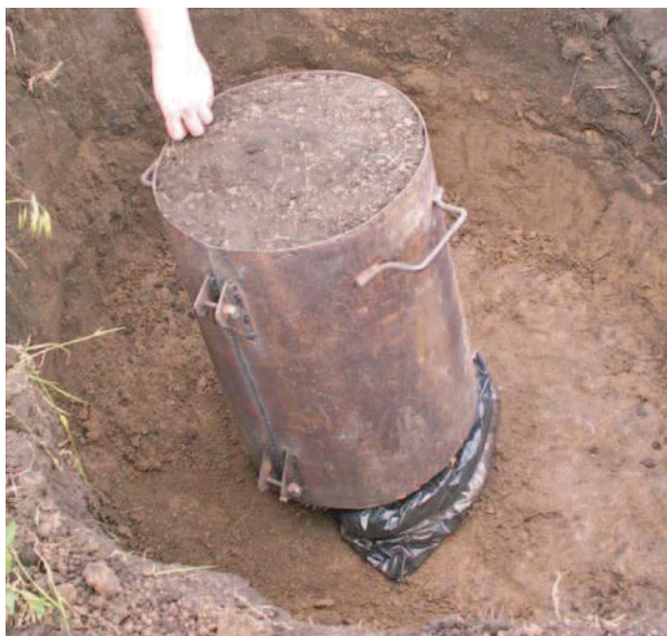
Рис. 1. Монолит наклонён, изолирующий материал подведён под первую половину его дна
