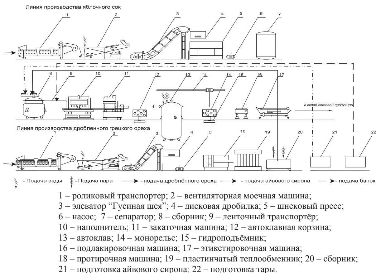
Рис. 3. Аппаратурно-технологическая схема производства многокомпонентных консервов «Фитонектар «Здоровье»
