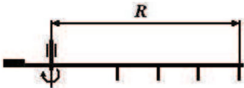
Рис. 4. Схема рабочего органа для рыхления почвы в рядке между кустами ягодных культур
