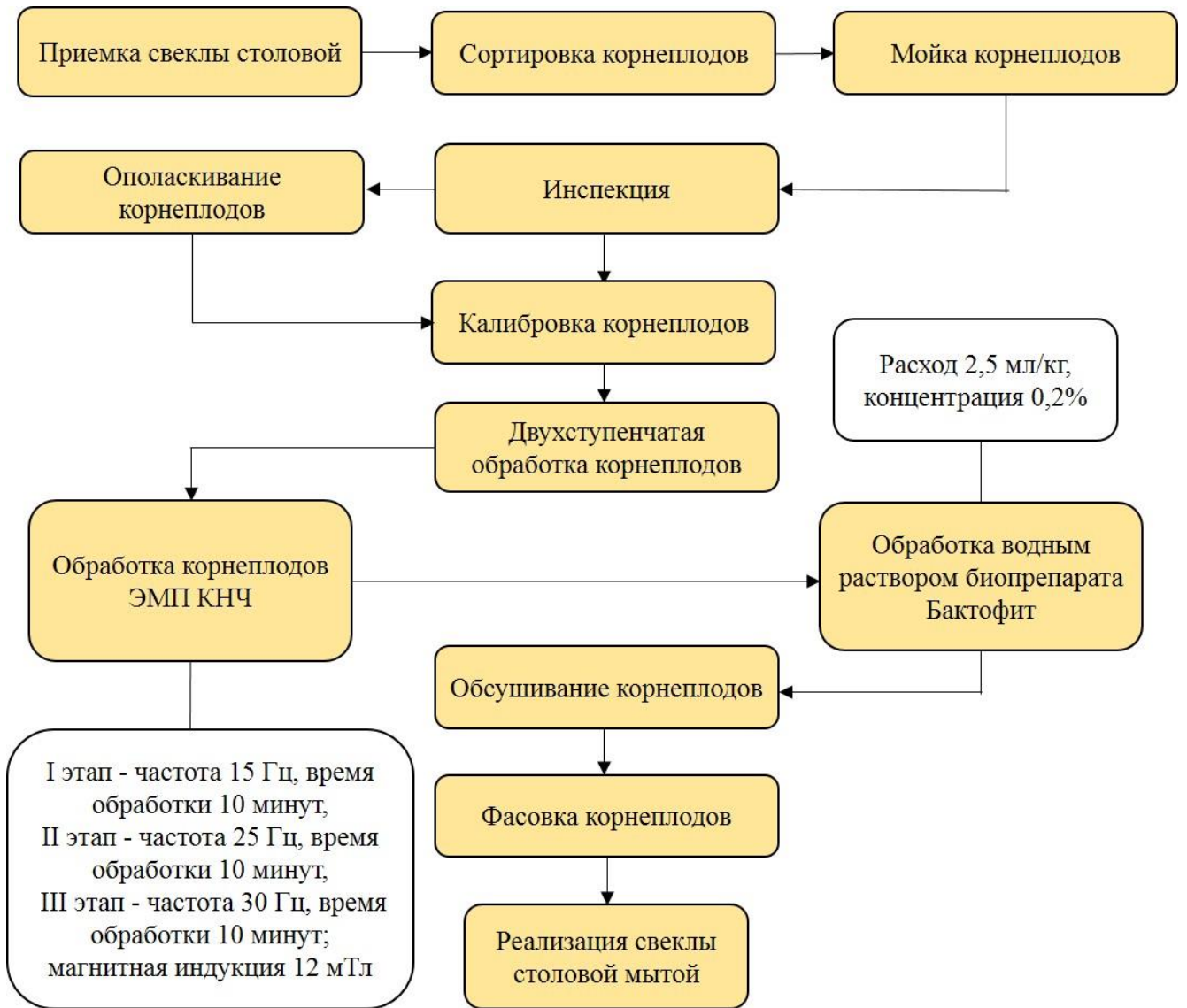
Рисунок 47 – Блок-схема подготовки свеклы столовой мытой к краткосрочному хранению в условиях искусственного охлаждения
