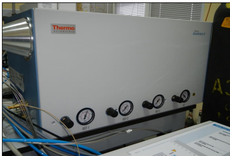
Рисунок 17 - Прибор «Gasbench II®» (Thermo Fisher Scientific)
