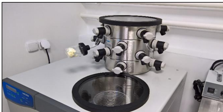
Рисунок 11 - Установка «Labconco®» (США) для лиофильного высушивания органических проб
