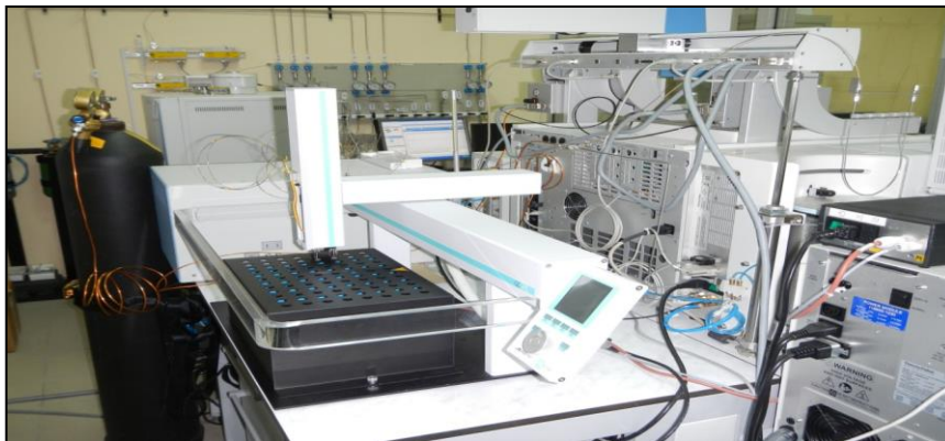
Рисунок 15 - Аналитический комплекс по изучению отношений стабильных изотопов кислорода ^{18}\text{O}/^{16}\text{O} в водной фракции объектов растительного происхождения методом изотопного уравнивания
