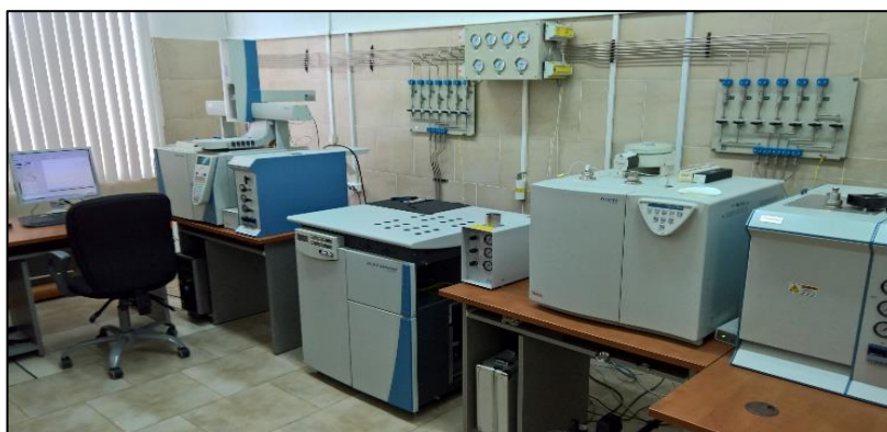
Рисунок 13 - Аналитический комплекс по изучению соотношений стабильных изотопов легких элементов в растительных объектах окружающей среды (Thermo Fisher Scientific)
