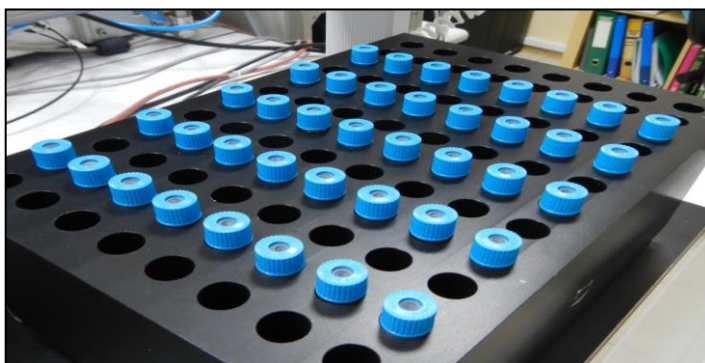
Рисунок 16 - Термостатируемый штатив для проведения реакции изотопного уравнивания в исследуемых пробах
