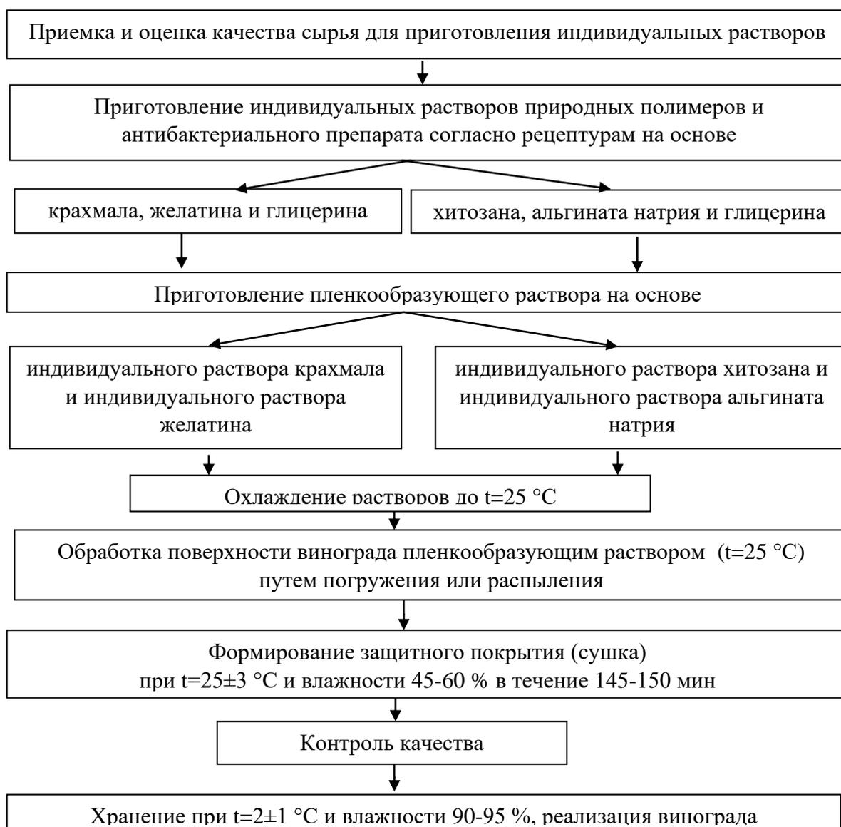
Рисунок 36 - Структурная схема приготовления и нанесения пленкообразующих покрытий на основе природных полимеров и антибактериального препарата
