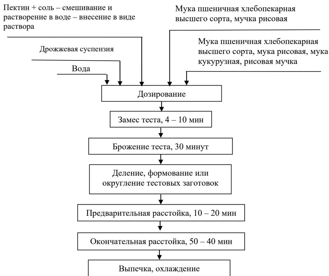
Рисунок 15 – Структурная схема производства хлебобулочных изделий с рисовой мучкой и на основе композитной смеси
